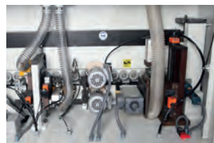
Radüs kazıma, Kanal açma ve Sıcak hava üfleme
