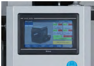
Dokunmatik kontrol paneli
