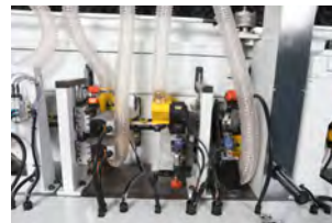
Kaba ve RADIUS Frezeleme Ünitesi
