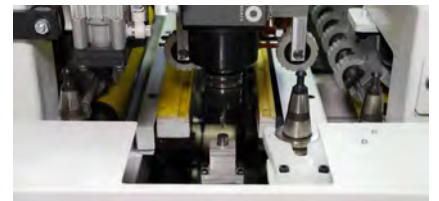
Otomatik takım boyu ölçme probu
