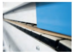
V kayışlı üst baskı sistemi
