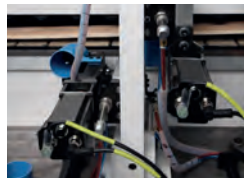
Servo kontrollü radyüs kazıma ünitesi
