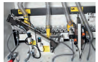
Baş son kesme ,alt-üst freze ünitesi
