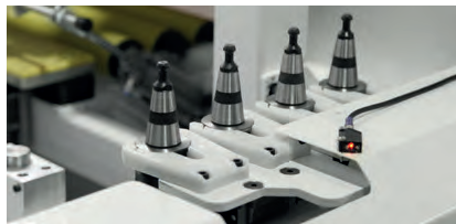
4'lü Otomatik Takım Tutucu (SMART)
