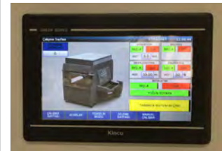
Dokunmatik kontrol paneli
